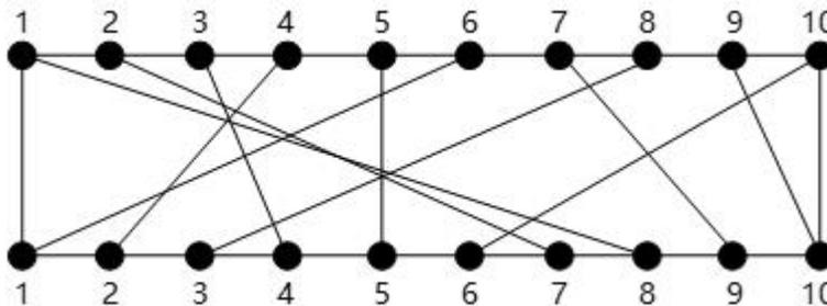
图 4-1 电路布线示意 在制作电路板时, 要求将这  $n$  条连线分布到若干绝缘层上, 在同一层上的连线不相交。现在要确定将哪些连线安排在一层上, 使得该层上有尽可能多的连线, 即确定连线集  $Nets = \{(i, \pi(i)), 1 \leq i \leq n\}$  的最大不相交子集。【分析问题】 记
